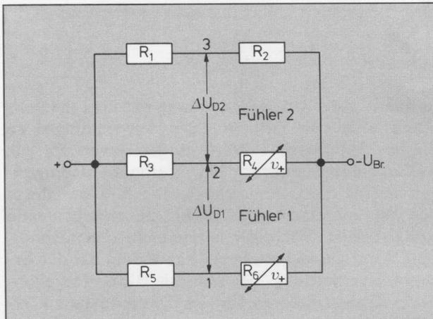
Abb. 1. Prinzipieller Aufbau der Meßschaltung, wobei  $R_4$  und  $R_6$  sich an der Meßstelle befinden und mit einer Fernleitung an die Brücke angeschlossen sind
