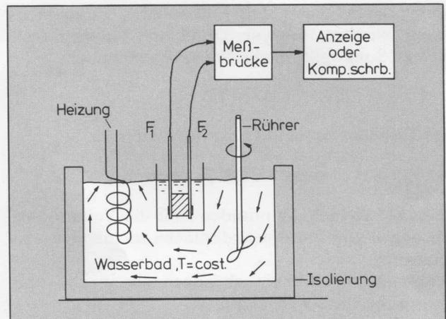
Abb. 3. Versuchsaufbau, in dem die Fühler  $F_1$  und  $F_2$  auf gleicher Temperatur gehalten werden.
